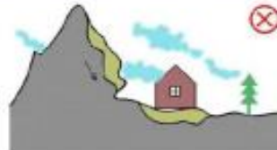
滑坡、崩塌、泥石流等地段
