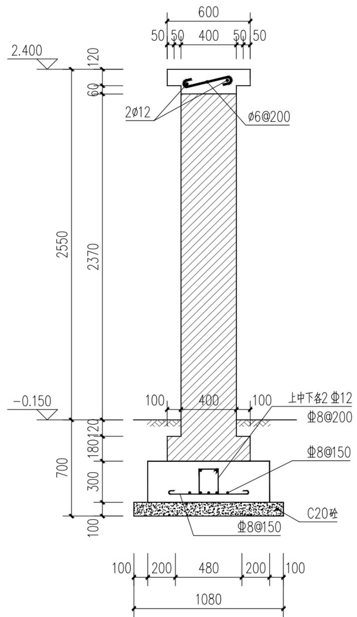
① 围墙门柱剖面图 1:25
