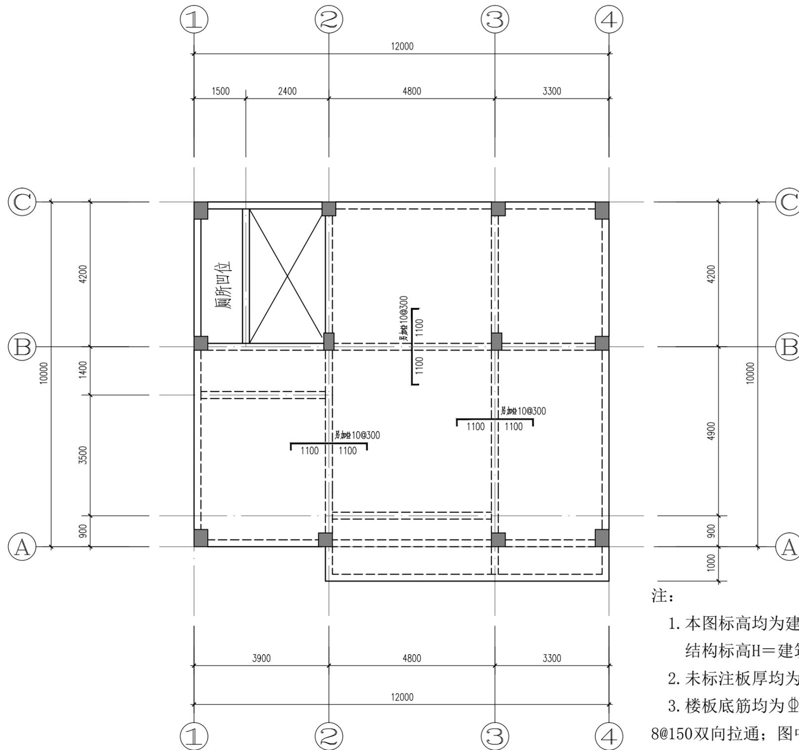
二层板配筋平面图 1:100
