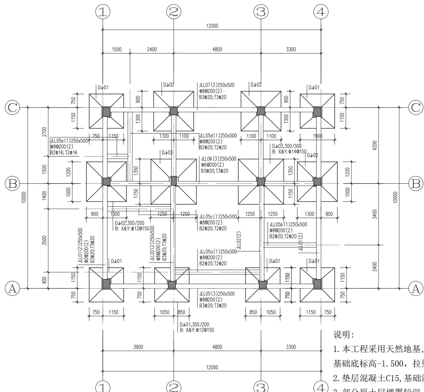
基础梁配筋平面整体表示法说明
