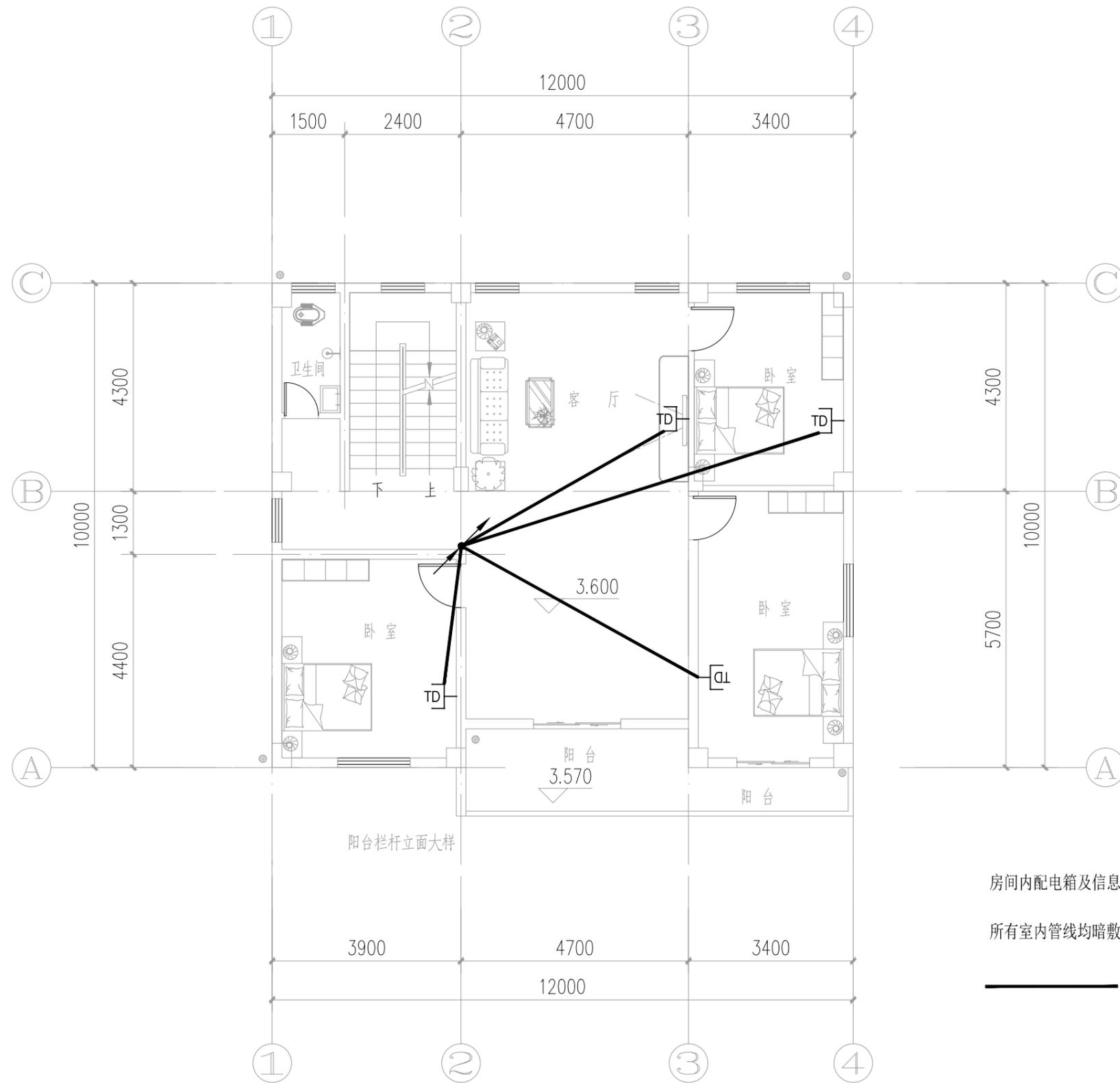
房间内配电箱及信息箱应错开安装，方便日后安装管线
