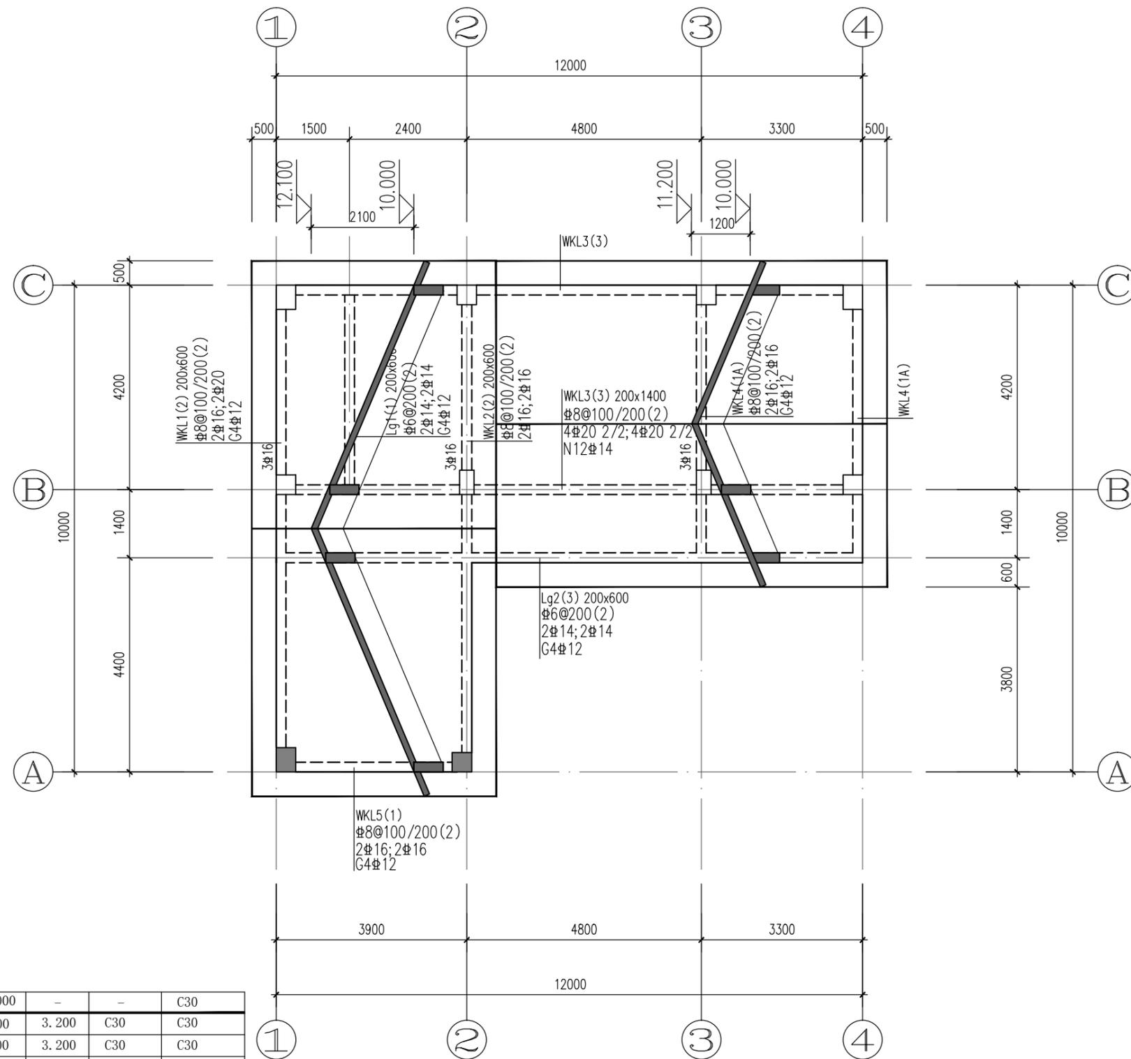
梯屋层梁配筋平面图 1:100
