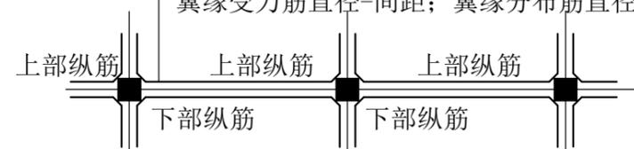
3:基础梁配筋图示意图中的支座底筋  $l_n$  取左跨  $l_n$  和右跨  $l_{n+1}$  的较大值
