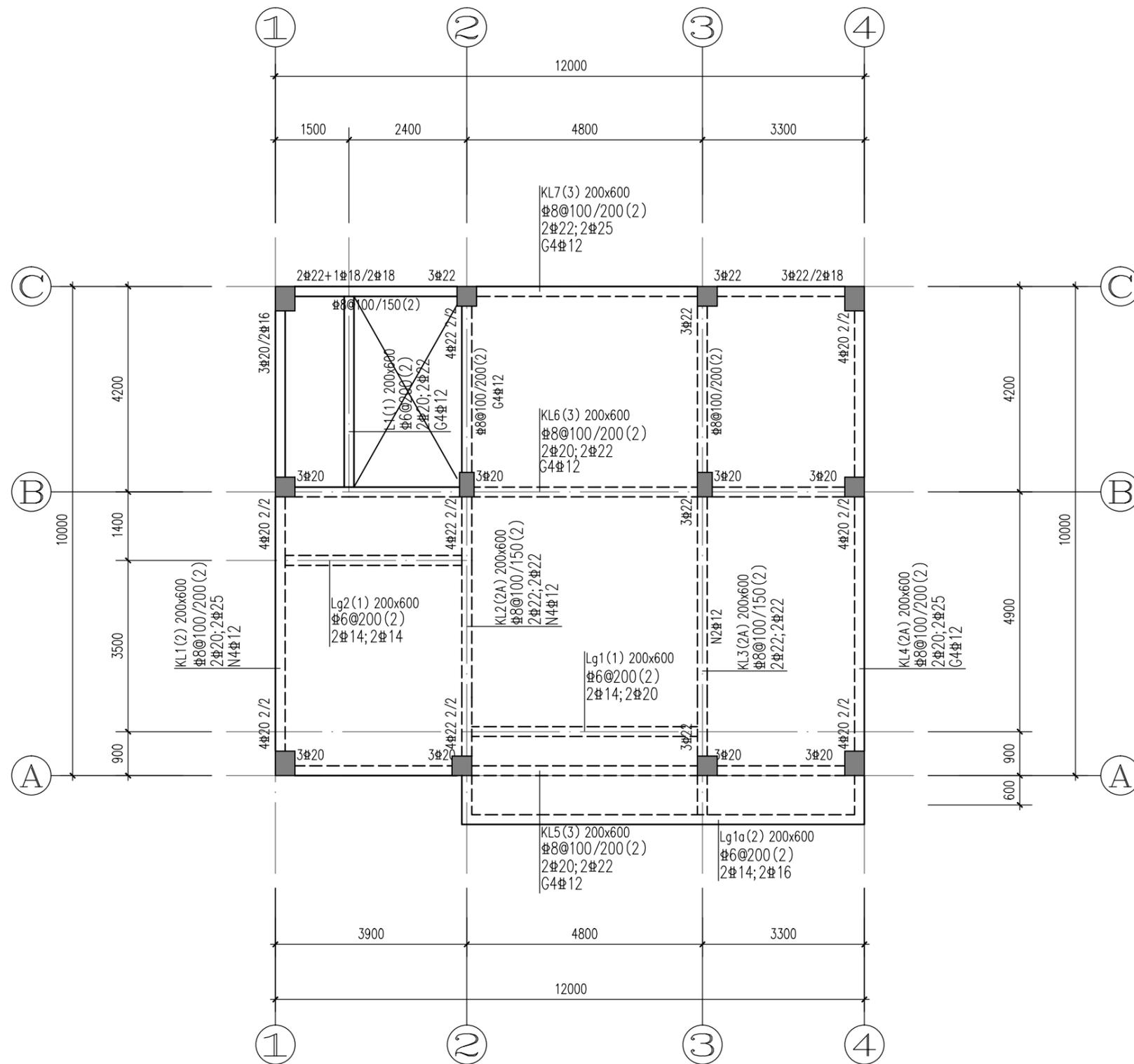
二层梁配筋平面图 1:100
