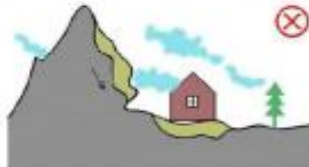
滑坡、崩塌、泥石流等地段
