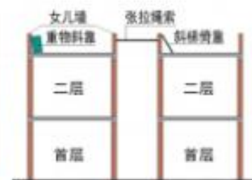
屋面女儿墙张拉绳索、重物斜靠 (✗)
