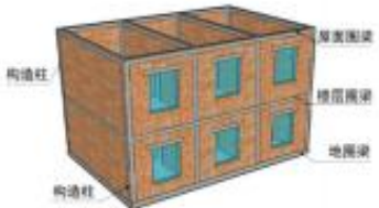
房屋设置圈梁、构造柱 (✓)
