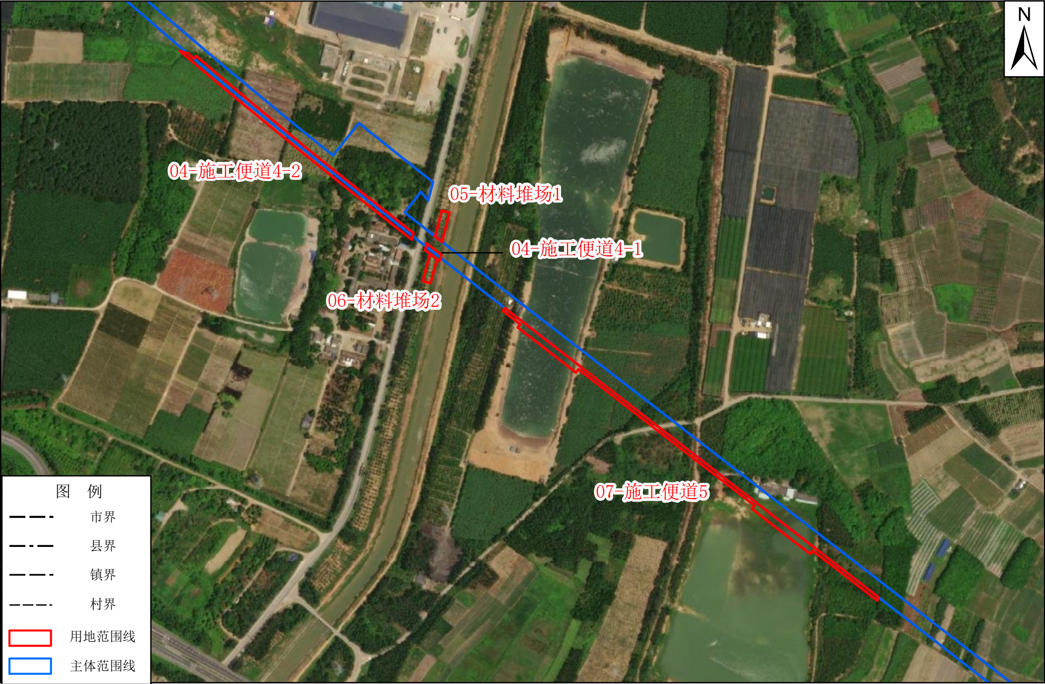
新建合浦至湛江铁路（广东段）站前工程HZGDSG-2标遂溪弃土场、拌合站、施工便道及材料堆场临时用地影像图三
