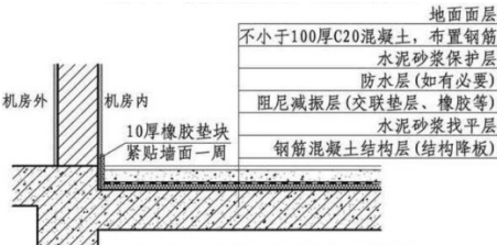
机房隔振浮筑楼板做法图
