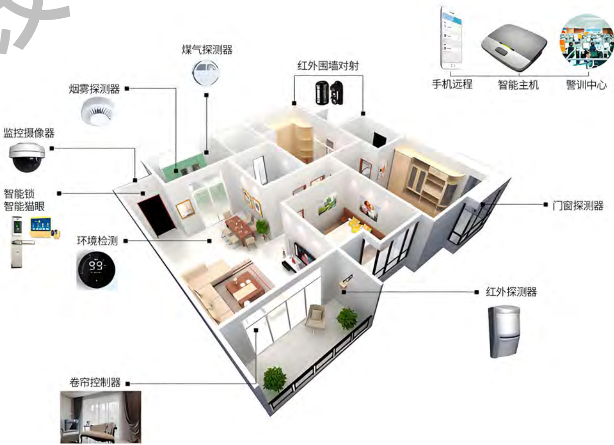
智能化家居安防系统安装示意
