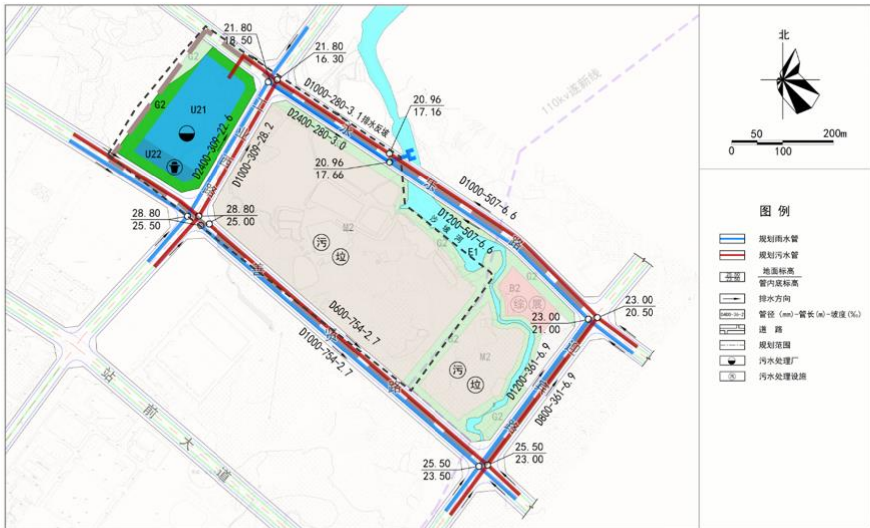
图 1.1-4b 服务范围雨污水规划管网图
