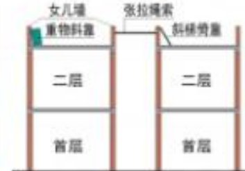
屋面女儿墙张拉绳索、重物斜靠 (✗)
